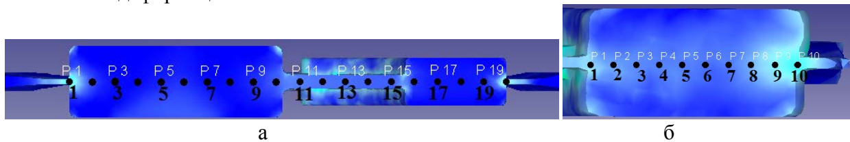
Рис. 7. Точечная схема для измерения НДС в указанных сечениях: а – сечение А-А; б – сечение Б-Б
